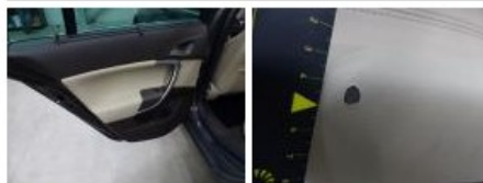
Dakstijl R, Kras(sen), Aanvaardbaar
