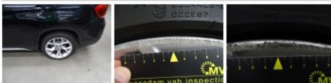
Alloy rim R L, Scratch(es), E - Replace
