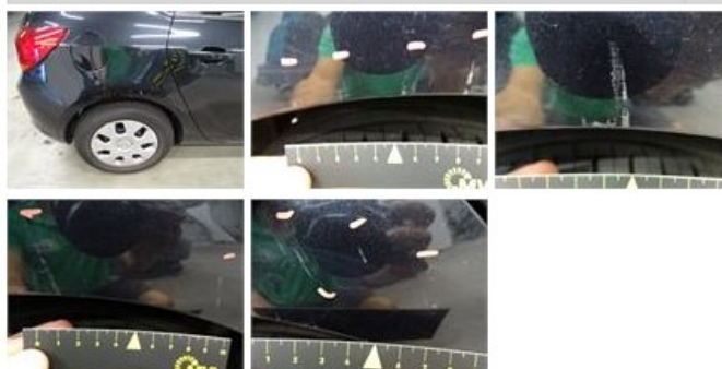
Door F R, Scratch(es), Acceptable
