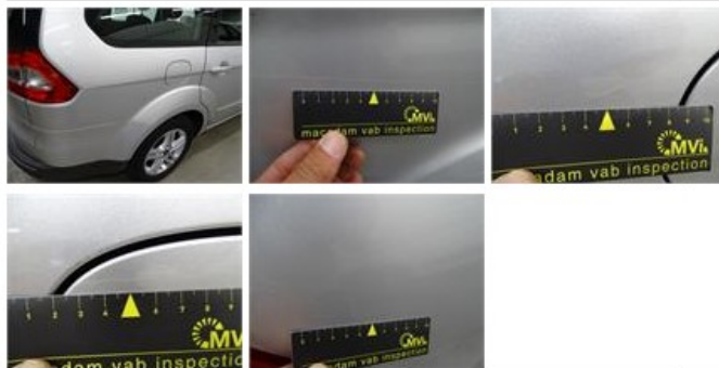
Door R R, Scratch(es), Acceptable
