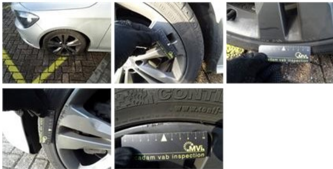
Tyre F R, Tear, E - Replace
