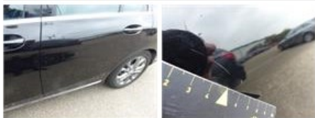
Door F R, Scratch(es), Acceptable
