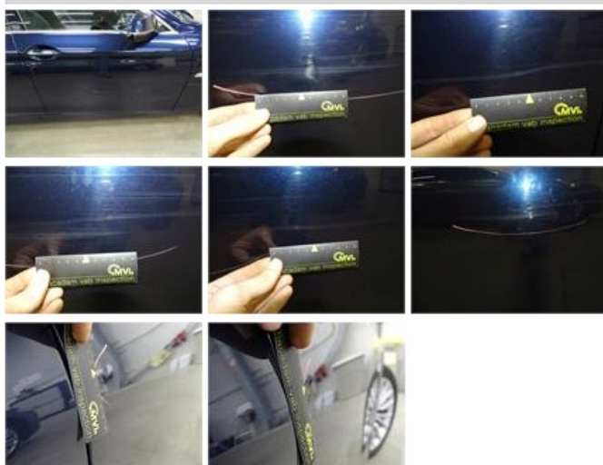
Door R R, Scratch(es), Acceptable
