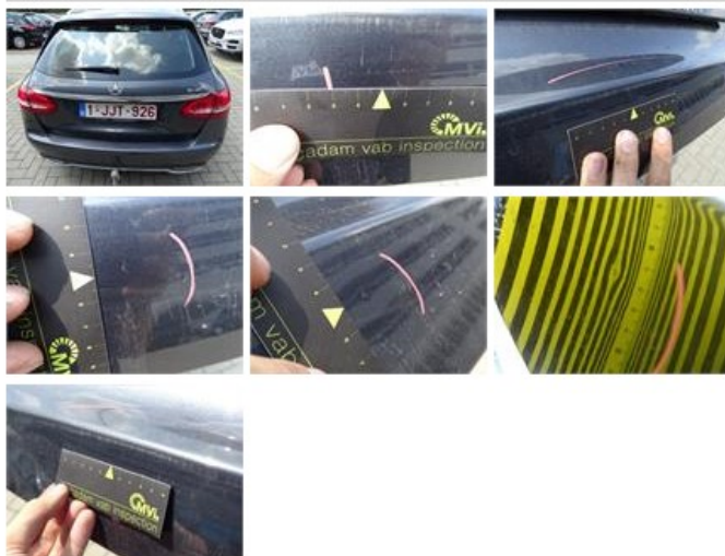
Door R R, Scratch(es), Acceptable
