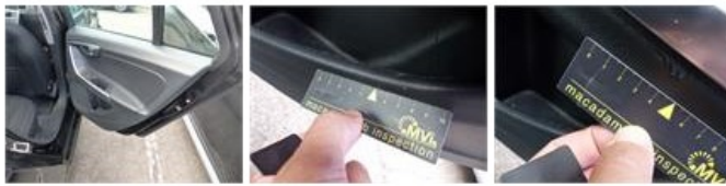
Door R R, Scratch(es), Acceptable
