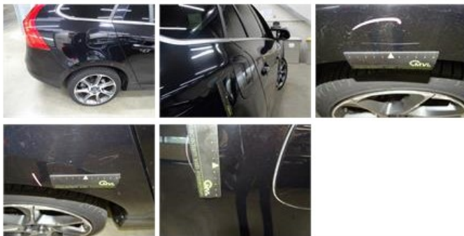
Door F R, Scratch(es), Acceptable
