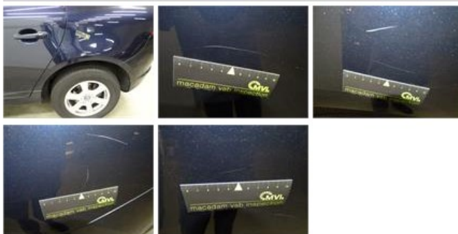
Rearlight R , Scratch(es), E - Replace
