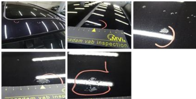
Door F R, Scratch(es), Acceptable
