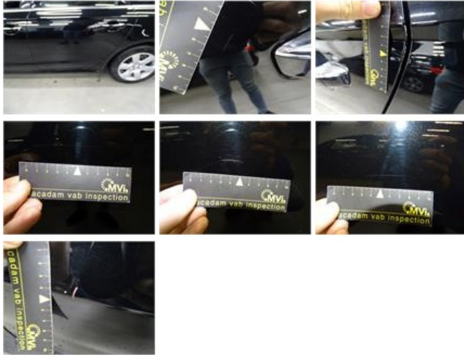
Door F R, Scratch(es), Acceptable
