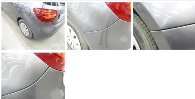
Door F R, Scratch(es), Acceptable
